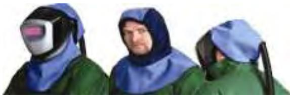
>> La nueva generación de protectores en tejido están fabricadas en **Tecaweld**. Una mezcla de 75% de algodón y 25% de fibras de kevlar que ofrece una resistencia mejorada al fuego y metales fundidos, así como una excelente flexibilidad y durabilidad. el tejido Tecaweld está homologado de acuerdo a los estándares siguientes: EN 470-1, EN 531, prEN 343 y Clase S-b.
